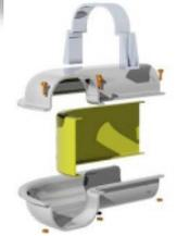
Konventionell durch Vakuumformen hergestellte Luftführung
