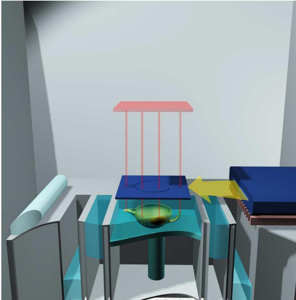
Das Maskensintern ist eine spezielle Form des Lasersinterns. Eine Maske (im Bild blau) wird für die jeweilige Schicht so konfiguriert, dass die an den Stellen, wo die Schicht entstehen soll, „Energie durchlässig“ ist. Beim Maskensintern wird immer eine Schicht komplett belichtet.
