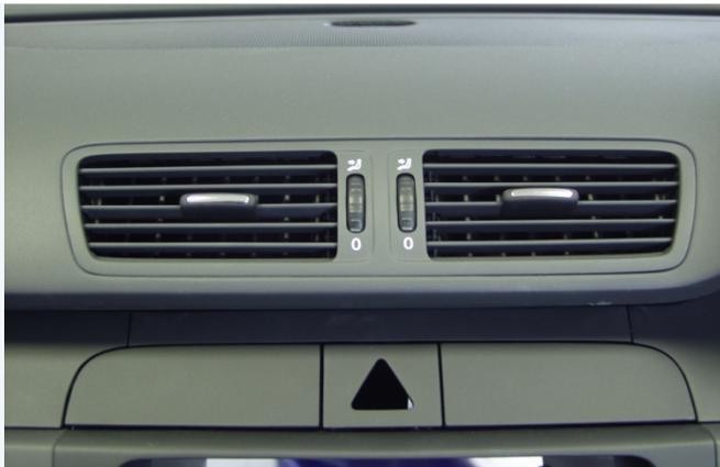
Bauteile aus verschiedenen Silikonwerkzeugen gegossen; lackiert und einbaufertig montiert
