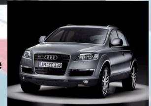
aufgebaut aus RIM-Teilen, Laser-Sinter-Teilen, Vakuumguss-Teilen, Oberfläche geschäumt
