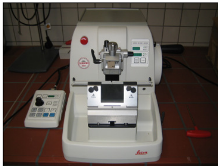
Probenvorbereitung mit Rotationsmikrotom
