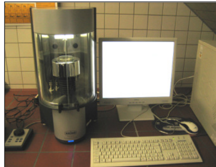
Messung der freien Oberflächenenergie
