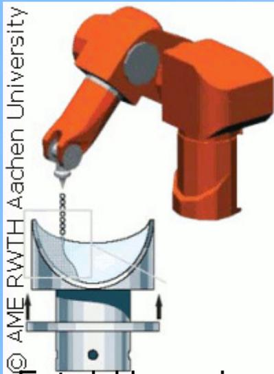
Für die Fertigung der Klappensegel bietet sich eine besondere 3D-Drucktechnik an. Hierbei werden mittels eines geeigneten Handlingsystems Tröpfchen von unterschiedlich harten Polymeren auf komplexen Freiformflächen und Kanten entlang exakt eingehaltener Bahnkurven hochpräzise dosiert. Somit lässt sich eine definierte und lokal variable Schichtdickenverteilung erreichen.
