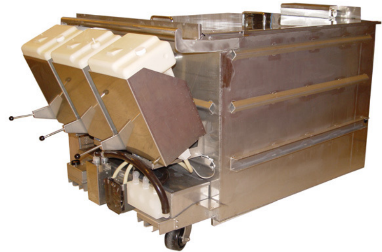
RDM – Resin Delivery Module Automatisierte Harzbehälter
